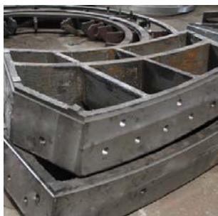
Перемычки пилонной станции проёмом 3,75 м
