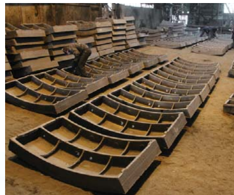
Обрубка и очистка тубингов
