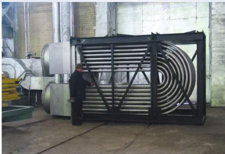
Рекуператоры петлевые трубчатые предназначены для утилизации тепла отходящих дымовых газов, имеющих температуру до 1000 °С, и подогрева воздуха, имеющегося для сжигания топлива в печных агрегатах, до температуры 350...400 °С.
