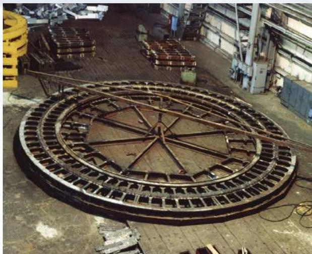
Печь используется в трубoproкатном производстве и предназначена для нагрева слитков перед прокаткой. Под печи движется по опорным роликам. От бокового смещения пода применены центрирующие ролики. Подина состоит из верхнего и нижнего колец, выполненных из сегментов.
